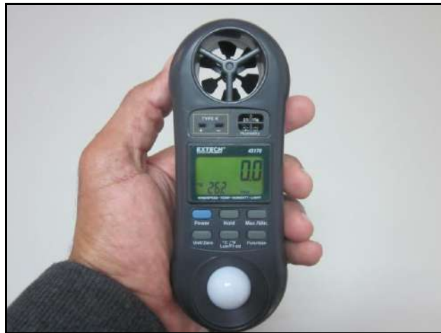
Foto 6.6.2.3-1. Estación meteorológica Extech 45170.
