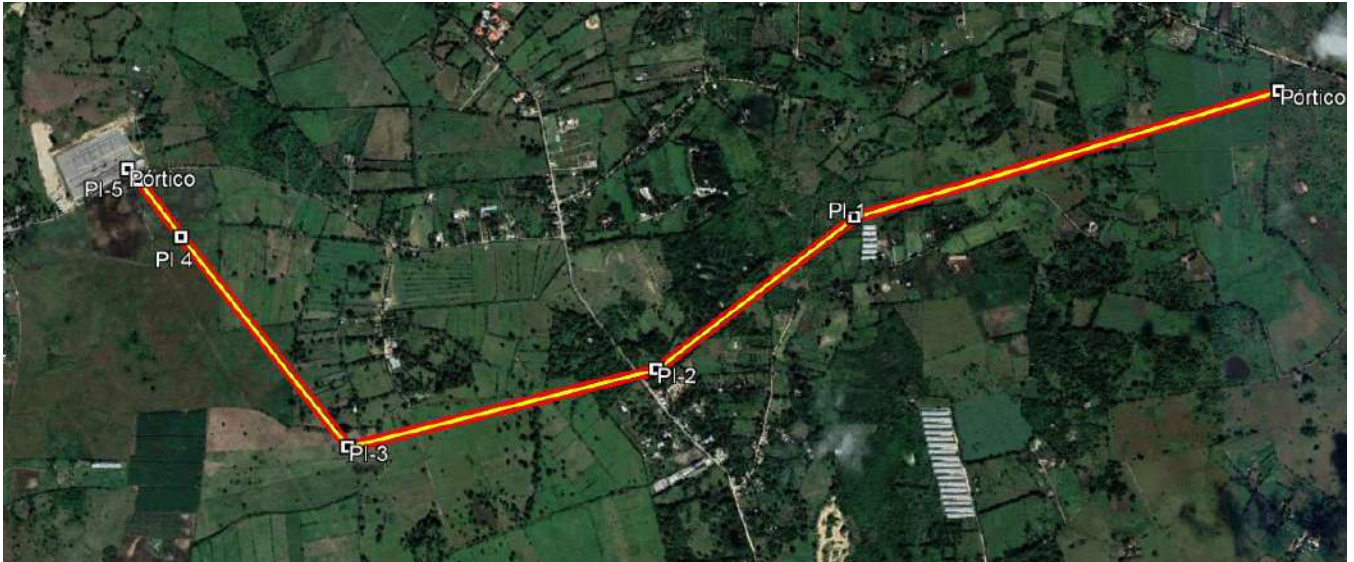
Figura 1.10.10-1. Línea de Alta Tensión de 138 kV y subestaciones del Parque Solar Mirasol y San Antonio de Guerra.
