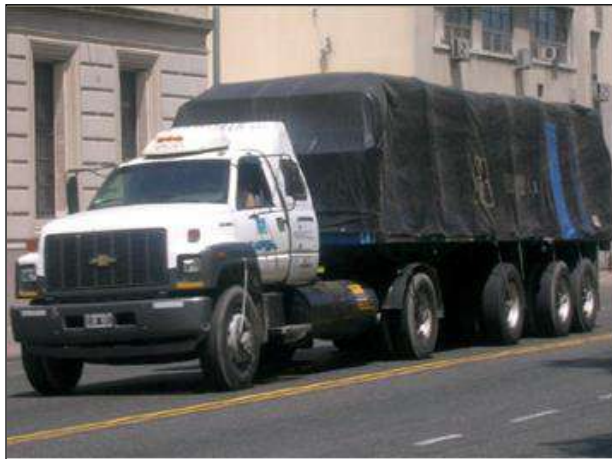
Foto 6.2.1-3. Vista de una carga debidamente cubierta con lona (tomada archivo Empaca).
