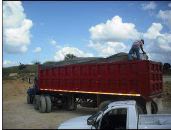
Foto 6.2.1-2. Vista de trabajador cubriendo la carga de un camión con una lona (tomada archivo Empaca).
